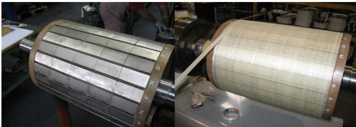
Costruzione e protezione di rotori PM / PM rotors, assembly and protection
